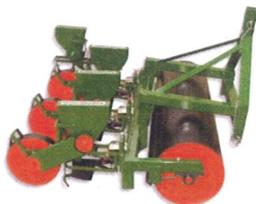
Le support du rouleau est indépendant de l'empattement du tracteur et surtout recommandé pour un passage simultané du rouleau en cas de sol meuble.
