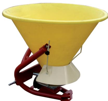
L'ECP 400 PVC est l'outil idéal pour effectuer les travaux de salage avec un tracteur. Sa cuve PVC et son système de distribution en inox le protègent contre la rouille et lui assurent ainsi une durée de vie optimale. Il peut être équipé (en options) d'un limiteur d'épandage en inox, d'un agitateur à sel et d'une bâche de protection.
